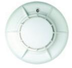
Le détecteur multicritères **ECO1002** dispose d'une chambre de mesure optique et d'une sonde thermique classe A1R, combiné avec un microprocesseur et des algorithmes avancés. La combinaison de caractéristiques optiques et thermiques accélère la réponse lors des situations d'incendie réelles, tandis que le risque de fausses alarmes, causées par l'environnement, est limité au strict minimum.
