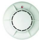
Le détecteur optique **ECO1003** est équipé d'une chambre de mesure optique et d'un ASIC (Application Specific Integrated Circuit). La combinaison de la conception unique de la chambre de mesure et d'autres caractéristiques techniquement avancées prolonge l'intervalle d'entretien, avant de devoir passer au nettoyage du détecteur.
