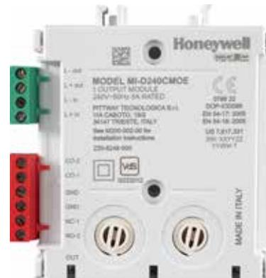
Le MI-D240CMOE est un module alimenté par une boucle qui contrôle une sortie bipolaire non supervisée (contact inverseur) adaptée à la gestion des charges de 240 Vac. pour gérer des charges de 240 V. Le relais de sortie est un dispositif bistable, qui s'enclenche dans l'état de marche ou d'arrêt lorsqu'il est commandé par la centrale incendie. panneau de contrôle.
